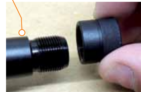
Cañón: sus estrías están fabricadas mediante el método de button rifled: una vez agujereada la barra de acero, se le pasa por su interior una varilla en cuya punta se encuentra un botón en forma de carozo de aceituna con las estrías grabadas en negativo. Este método es muy usado en los rifles de competición por su precisión. Además, el exterior del cañón es del tipo aflautado para alivianar su peso. En la punta del cañón aparece una rosca con su correspondiente protector, que sirve para la colocación de un freno de boca. Al costado del cañón encontramos no solamente la marca de su fabricante, sino también las del Banco de Prueba, el calibre y el paso de estrías. Según el modelo, los hay contruidos en acero al carbono AISI4140 o en acero inoxidable AISI416.
