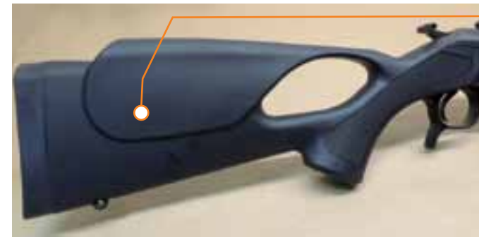
Culata: consta de dos partes: la culata y la chimaza. Según los modelos, hay una que podríamos llamar convencional que va en el cañón de 23 pulgadas y otra para el modelo Take Down de sólo 16,5 pulgadas, que es del tipo Thumbhole: posee una cavidad donde introducimos el dedo pulgar para mejor sujeción del mango-pistola, muy cómoda por cierto. Está fabricada en polímeros de alta resistencia y es de color negro. La chimaza o apoyamanos, también sintética, se puede remover fácilmente mediante una palanca, al estilo de las escopetas de un solo cañón. Todos los estilos de culata llevan en su parte trasera una generosa cantonera de un elastómero especial, denominada por fábrica como Crushzone.
